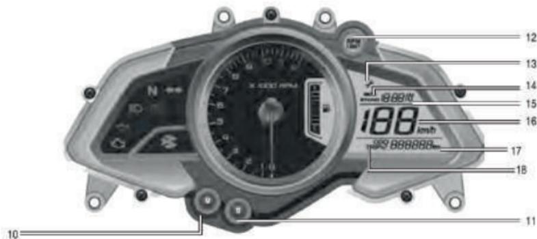
**10. Botón MODE:** Botón MODE utilizado para cambiar el modo mientras se selecciona y se configura el recordatorio de Trip1, Trip2, odómetro, reloj y servicio.
