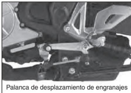
Palanca de desplazamiento de engranajes
